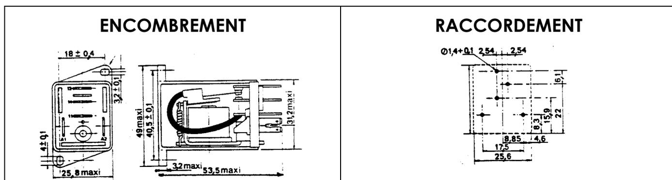
Le relais 1566 permet de commander des charges importantes avec un faible encombrement. Son circuit de contact 1 inverseur ou 1 contact normalement ouvert (NO) a une capacité maxi. de 20 A. sous 380 V AC et est commandé par une bobine de faible puissance 1,2 à 1,5 W en continu, 1,8 à 2 VA en alternatif.
